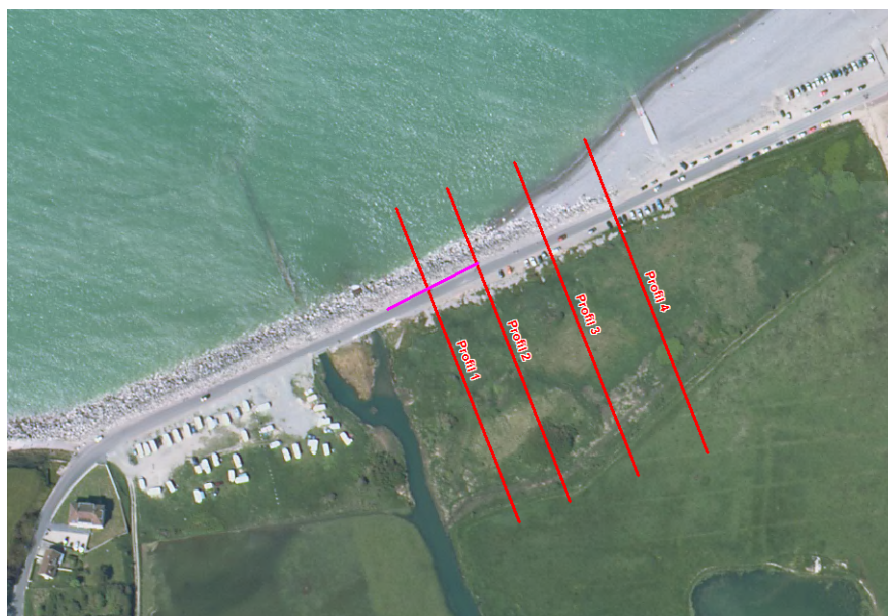
Figure 17 : tronçon de digue proposé pour la brèche
